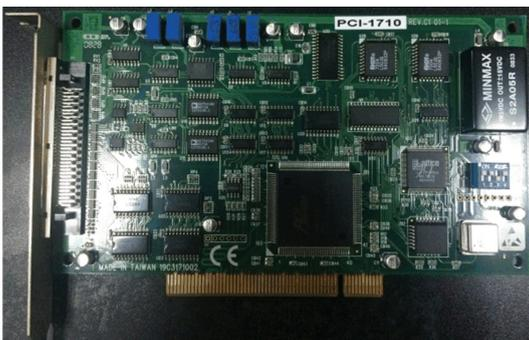
图 3 研华 PCI-1710/U 数据采集卡
